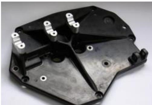
Figure 17 : Pédalier Carbone Forgé
