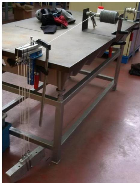
Figure 11 : Système d'enroulement manuel
