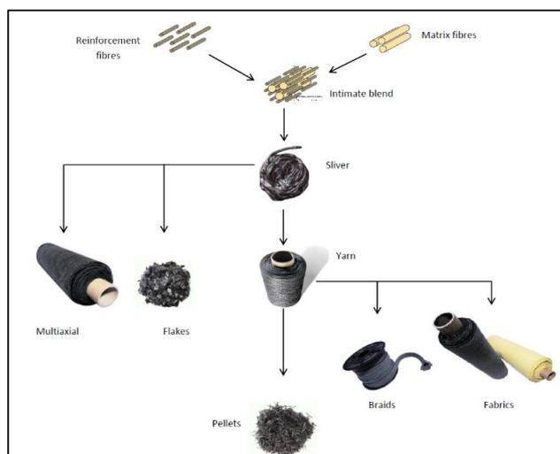
Figure 4 : Fabrication fibres co-mêlées craquées et leur utilisation
