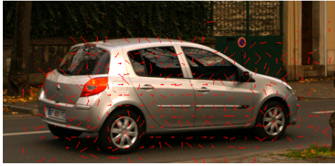
(d) Motion estimation result of (b), block size of 16 \times 16
