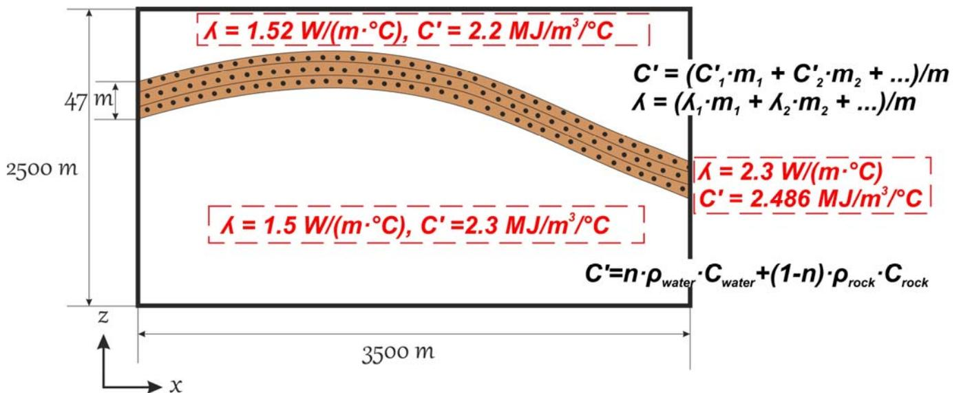
Fig. 4.9. Thermal parameters used in modelling
