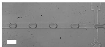
FIGURE V.21 – Gouttes contraintes par les parois dans un canal plus fin de 50  $\mu$ m, ce qui permet d'éviter leur désorganisation.
