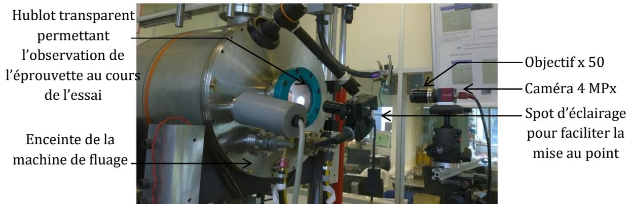
Figure 4.10 – Photo du dispositif permettant l'acquisition d'images pour la corrélation d'images.
