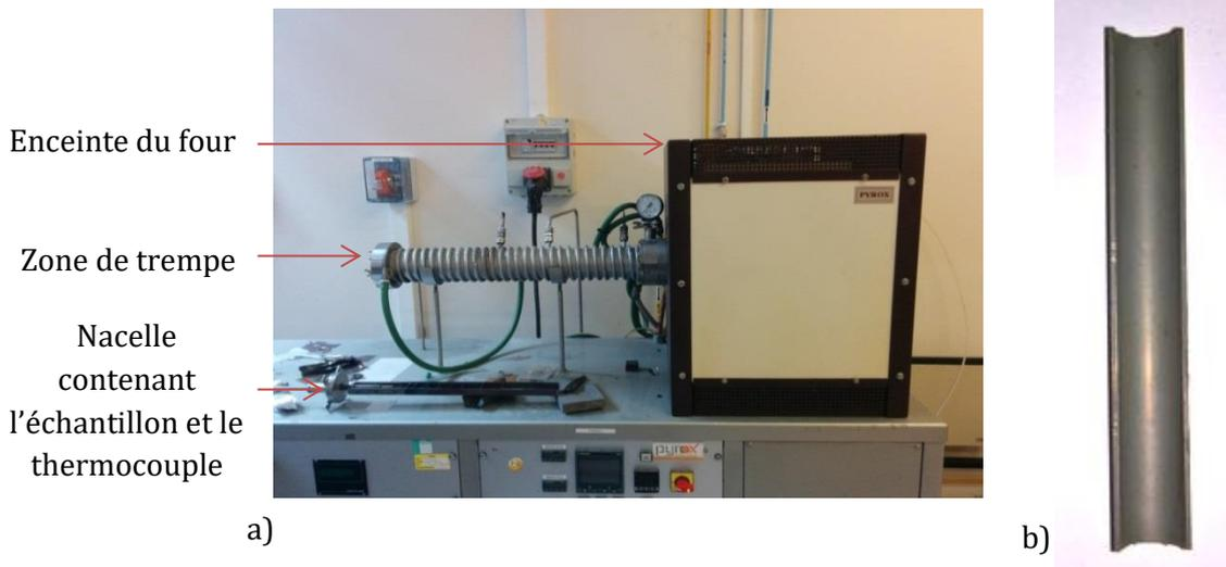
**Figure 2.13 – Photographies a) du four PYROX2 et b) d'un échantillon après traitement thermique.**
