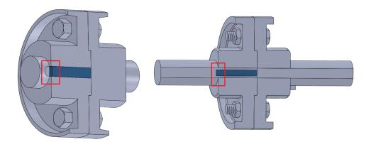
Figure 25: Différents contacts entre la clé et l'arbre des modèles d'assemblage de requête (à gauche) et de comparaison (à droite)
