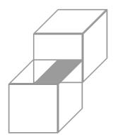
Figure 11: Deux pièces avec un contact de type surface
