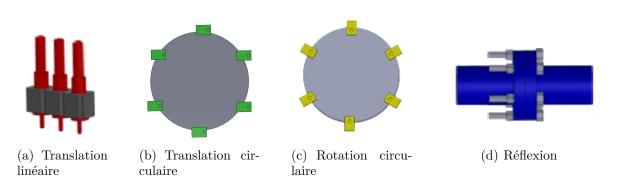
Figure 7: Exemples de modèles avec des pièces répétées
