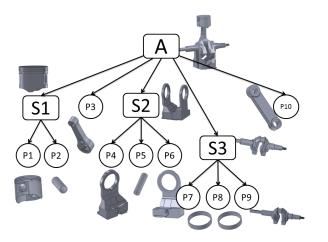
Figure 6: Exemple de couche de structure d'un EAM
