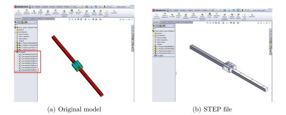
Figure 1: Exemple de perte d'information stockant un modèle au format STEP 214
