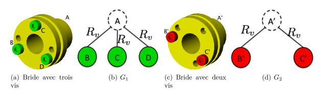
Figure 16: Exemple de deux modèles d'assemblage et leurs multi-graphes EAM  ${\cal G}_1$  et  ${\cal G}_2$
