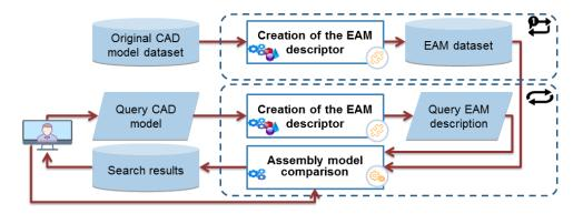
Figure 4: Cadre de récupération d'assemblage
