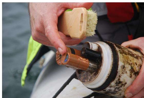
FIGURE B.8 : Sonde multiparamètres nke instrumentation montée sur les chaînes latérales immergées dans le lac de Crêteil (José Rodolfo scarati Martins)
