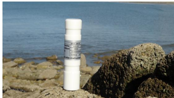
FIGURE B.7 : Capteur de température de l'eau nke instrumentation monté sur les chaînes latérales immergées dans le lac de Crêteil (<http://www.nke-instrumentation.fr>)
