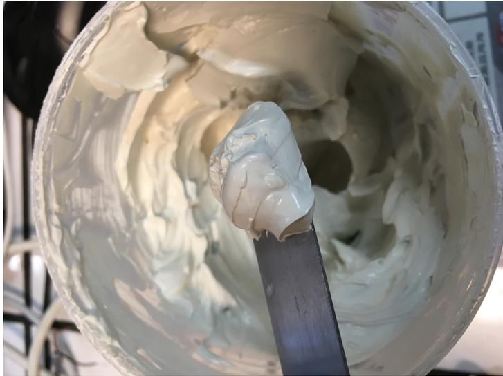
FIGURE 2.2 – Photographie du kaolin après préparation et homogénéisation.
