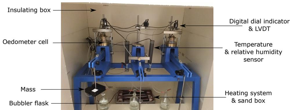
FIGURE 6.1 – Dispositif expérimental développé pour l'étude de l'influence de la température et de l'humidité relative sur le comportement oedométrique.
