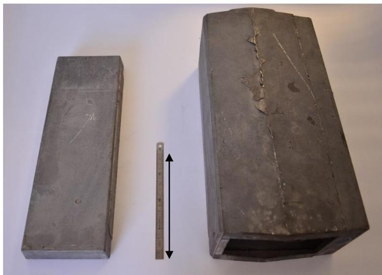
FIGURE 0-3. Billette (à gauche) et culasse type (à droite).
