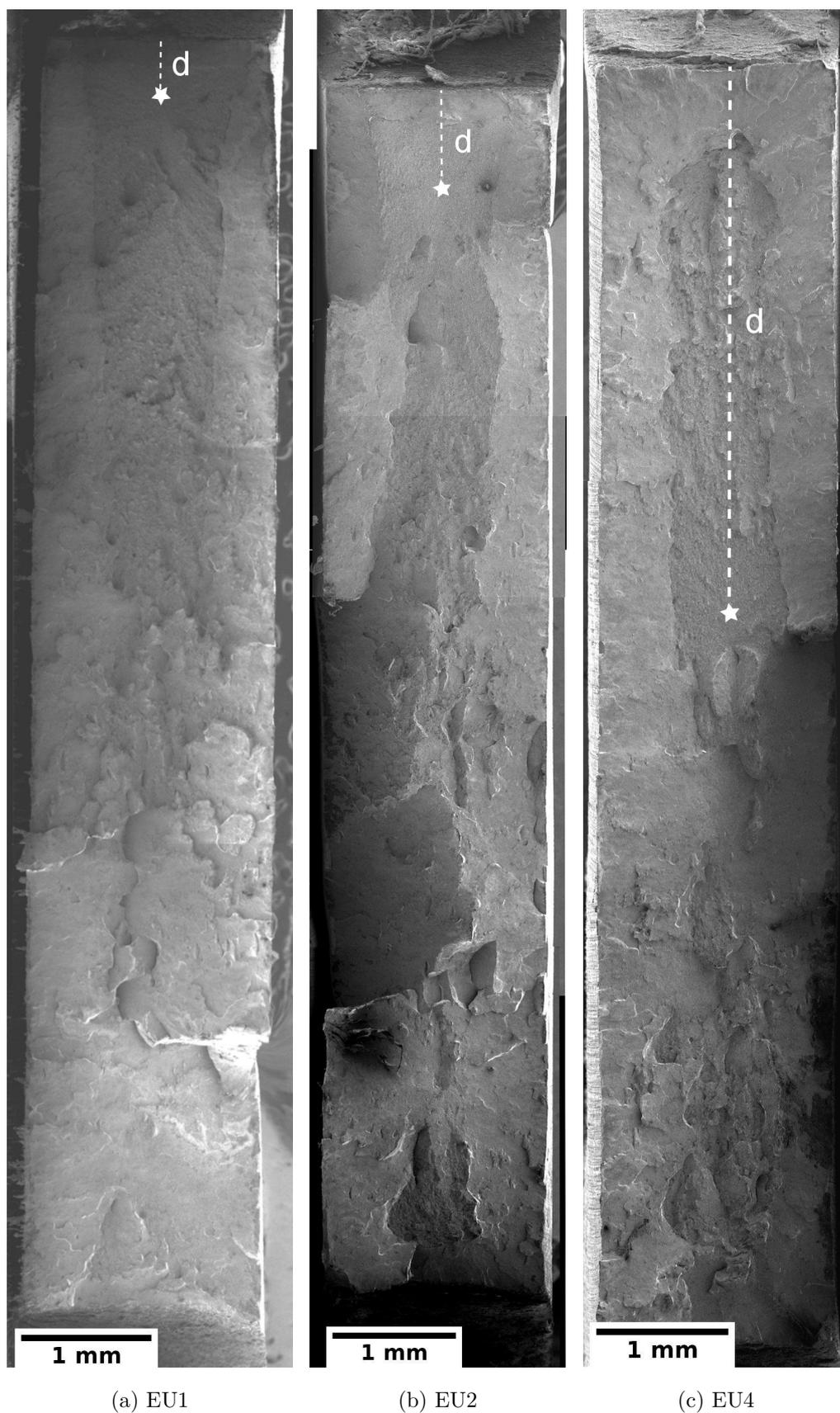
FIGURE IV.12: faciès de rupture des éprouvettes EU - ☆ correspond à l'emplacement supposé du point d'amorce de la rupture
