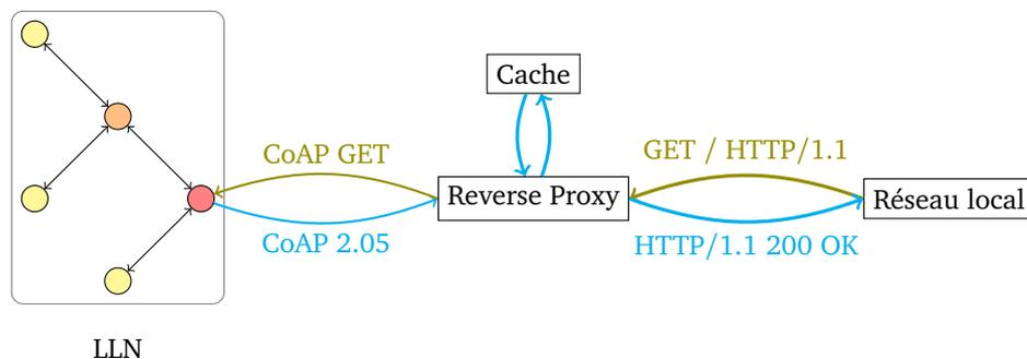
FIGURE 2.5 – Architecture d'un Reverse Proxy Cache (RPC)
