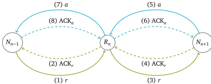
FIGURE 4.2 – Schéma de transmission d'un paquet par routeur
