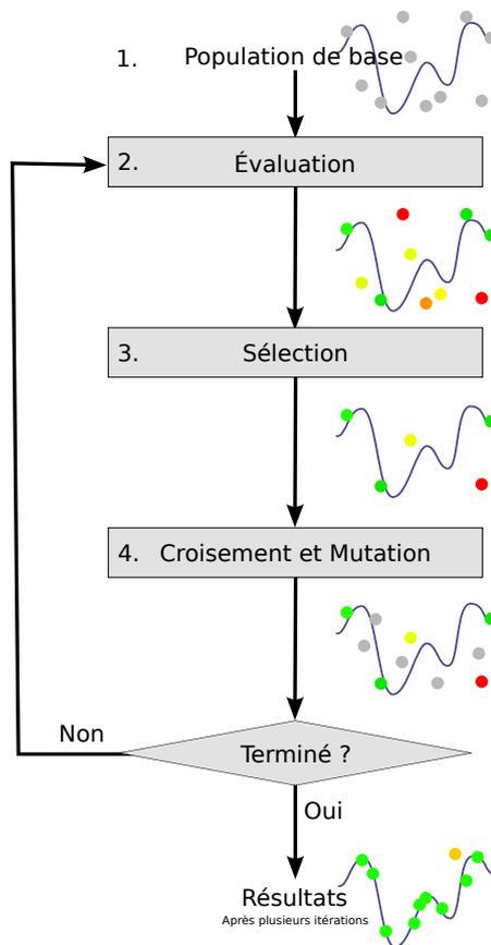
FIGURE 4.3 – Schéma des étapes d'un algorithme génétique
