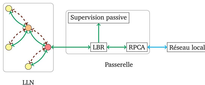
FIGURE 6.1 – Schéma de la passerelle proposée
