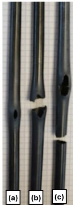
Figure I-13 : Photographies des trois états caractéristiques d'une gaine ballonnée-éclatée après une trempe simulant un scénario d'APRP (EDF R&D) : (a) non-rupture lors de la trempe, (b) rupture fragile dans le ballon, (c) rupture fragile hors ballon dans la zone d'hydruration secondaire.
