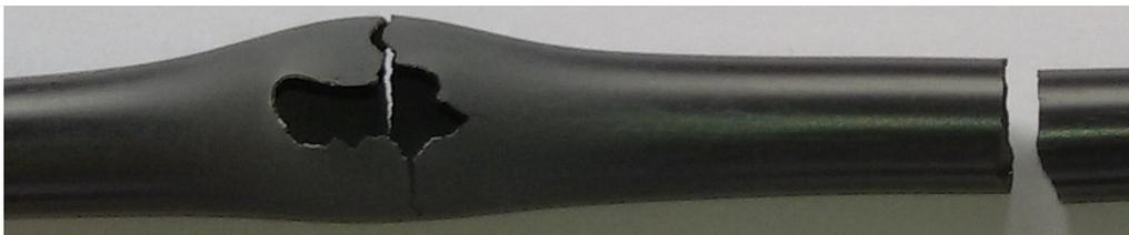
Figure III-42 : Illustration de la compétition entre les deux mécanismes de rupture fragile lors d'un essai semi-intégral APRP. Éprouvette rompue hors zone ballonnée et présentant une fissure orthoradiale au droit de l'éclatement. (Les lèvres de l'éclatement, très oxydées et fragiles, se sont effritées en fin d'essai, d'où cette forme de fissure d'éclatement incomplète.)
