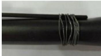
Figure III-14 : Fixation du thermocouple à +50 mm au-dessus du plan milieu via une ligature de fil platine.
