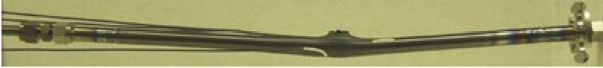
Figure III-26 : Photographie d'une éprouvette de Zy-2 type 9x9 ayant subi un essai semi-intégral APRP type ANL. Mise en évidence de la déformation en flexion de la gaine lors de l'essai [22].
