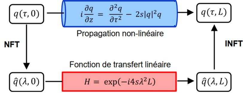
**Figure 5.1:** Comparaison d'une transmission NFDM et linéaire.
