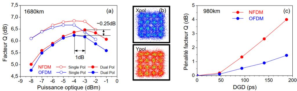
**Figure 5.3:** Performances obtenues: (a) résultats NFDML et OFDM en mono- et double polarisation, (b) Constellation s NFDML à -3dBm, (c) Sensibilité à la DGD.
