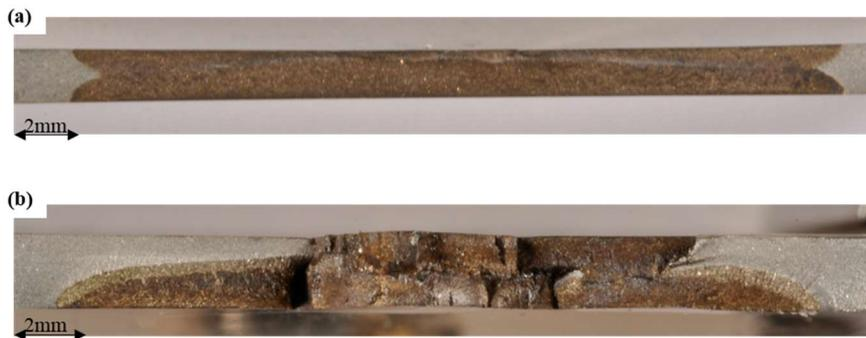
Figure III.23 : Faciès de rupture après sollicitation dans l'eau distillée à la température ambiante
