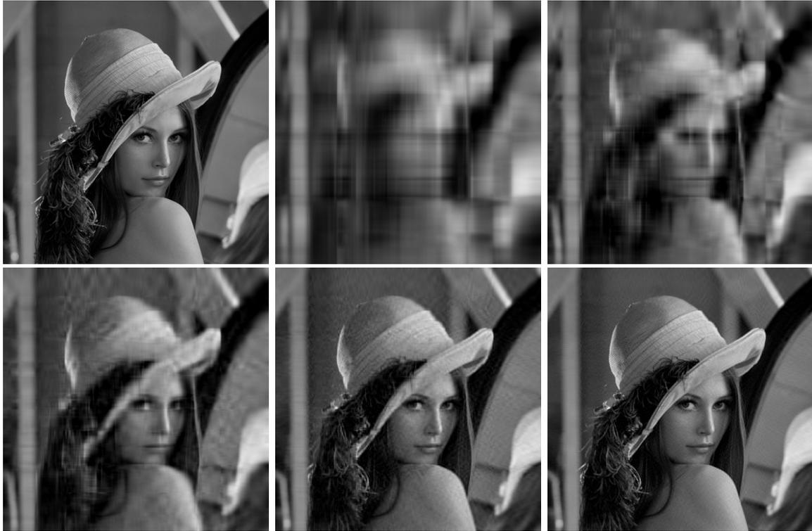
FIGURE II.1 – Image originale classiquement utilisée en traitement d’images puis approximations successives par SVD de rang 5, 10, 20, 50 et 100
