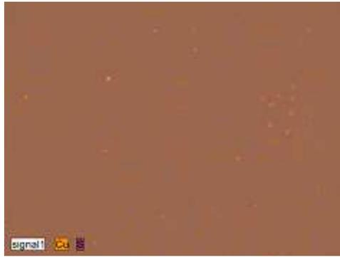
FIGURE 4.10 – Cartographie chimique des éléments Cu et S en surface d'une couche mince de  $\text{Cu}_x\text{S}$ , synthétisée dans le réacteur Beneq TFS-200, pour  $T_{\text{dep}} = 160\text{ °C}$ , d'environ 9,4 nm (400 cycles), dont la croissance a été effectuée avec le programme  $[\text{Cu}(\text{acac})_2]/\text{N}_2/\text{H}_2\text{S}/\text{N}_2 = [0,5/0,15/0,5/10/0,5]/5/0,5/5$  s, prise par MEB-EDS.
