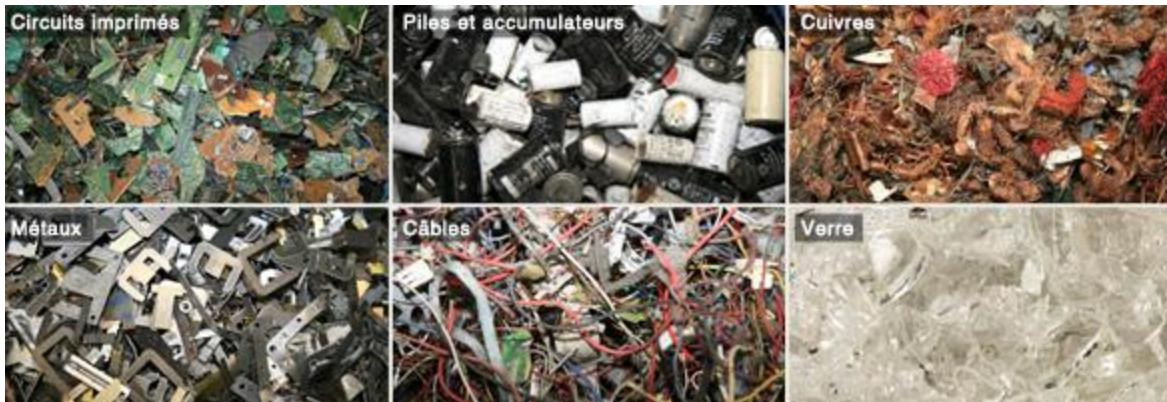
*Figure 4 - Fractions typiques obtenues après tri en centre de recyclage<sup>17</sup>. Le démantèlement manuel est utile à la récupération de produits entiers tels que les piles ou à la séparation des pièces de gros appareils, tandis que le broyage couplé à des techniques séparatives automatiques générera des sous-ensembles de matrices, facilitant ainsi leur recyclage*
