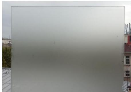
Figure 147. Photo d'un film de HEA (2 mol% réticulant, 1 mol% amorceur, épaisseur 20 µm) obtenu dans un convoyeur UV à 2 m/min et 600 mW/cm<sup>2</sup>.
