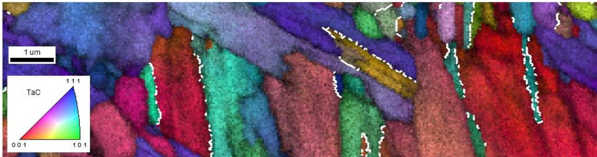
Figure 4.68 : Cartographie IPF de la couche de MC (figure 4.67 zone 1) d'un échantillon de TaW2,5% cimenté 1 h à 1600 °C, Joints blancs : joints de macles selon <111> avec une désorientation de 60°.
