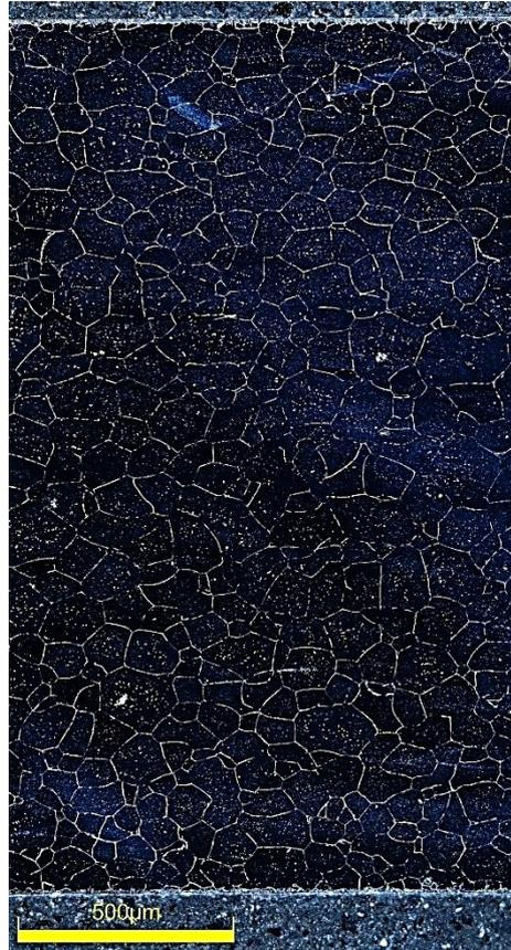
Figure 4.105 : Micrographie optique en champ sombre de la coupe d'un échantillon de TaW2,5% cémenté 10 min puis recuit 6 h à 1600 °C.
