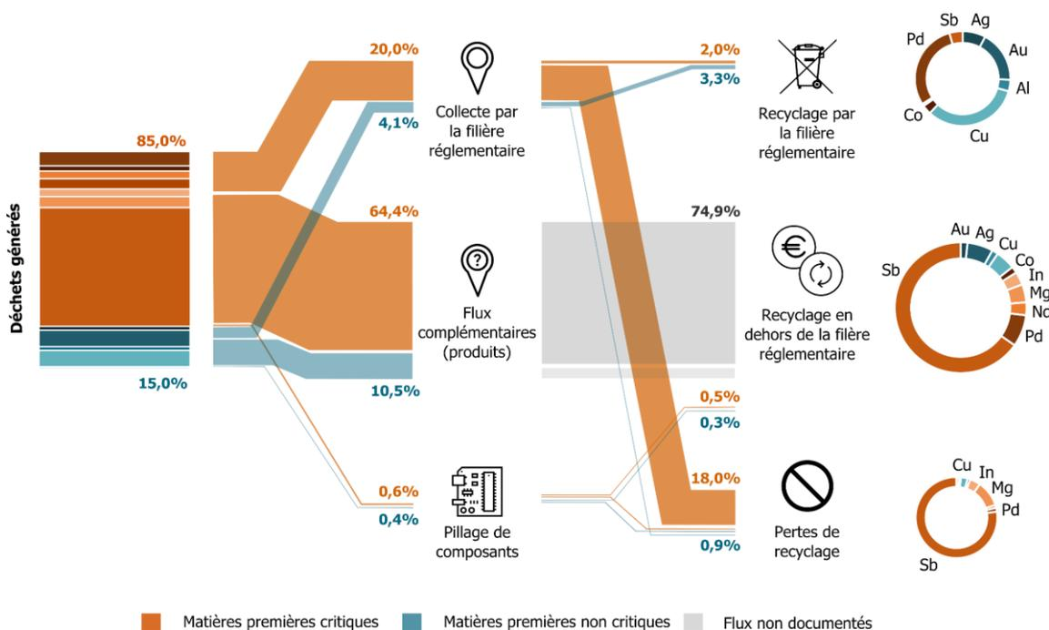
Figure 9.11. Flux des écrans DEEE: matériaux cibles générés, collectés et recyclés (approche basé sur la criticité).
