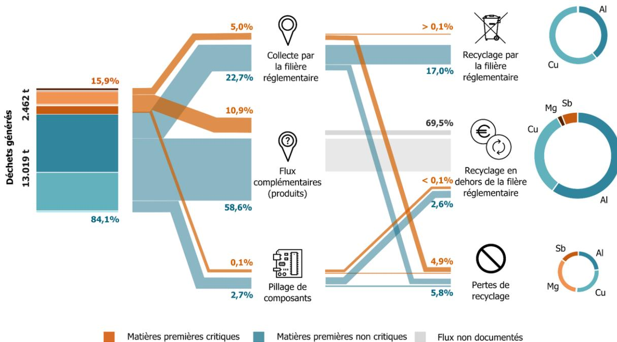
Figure 9.5. Flux des écrans DEEE: matériaux cibles générés, collectés et recyclés (approche basée sur le poids).
