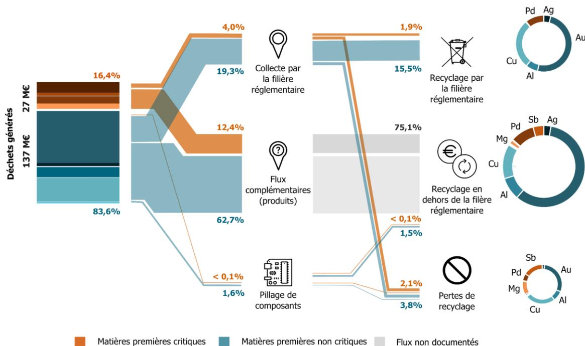
Figure 9.9. Flux des écrans DEEE: matériaux cibles générés, collectés et recyclés (approche économique).
