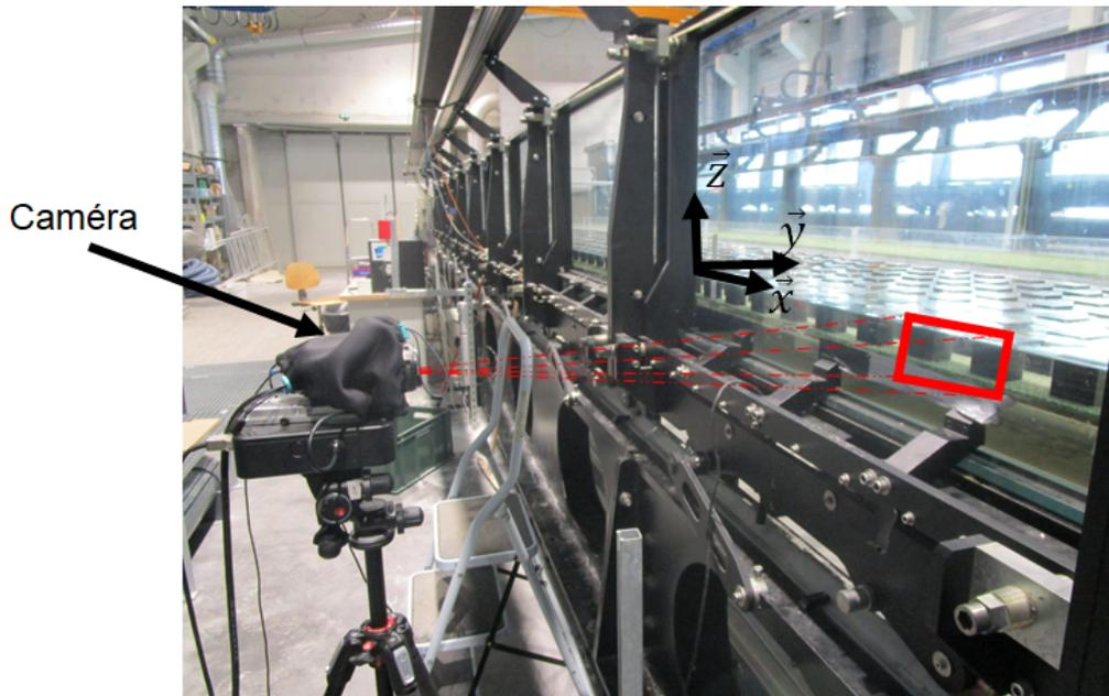
Figure 2.20: Photo du dispositif de prise de vue : le cadre rouge délimite le champ visuel de la caméra au travers de la paroi
