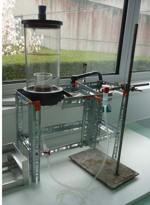
FIGURE 4.1 – Microcosme permettant de réaliser des incubations à un potentiel hydrique fixé.
