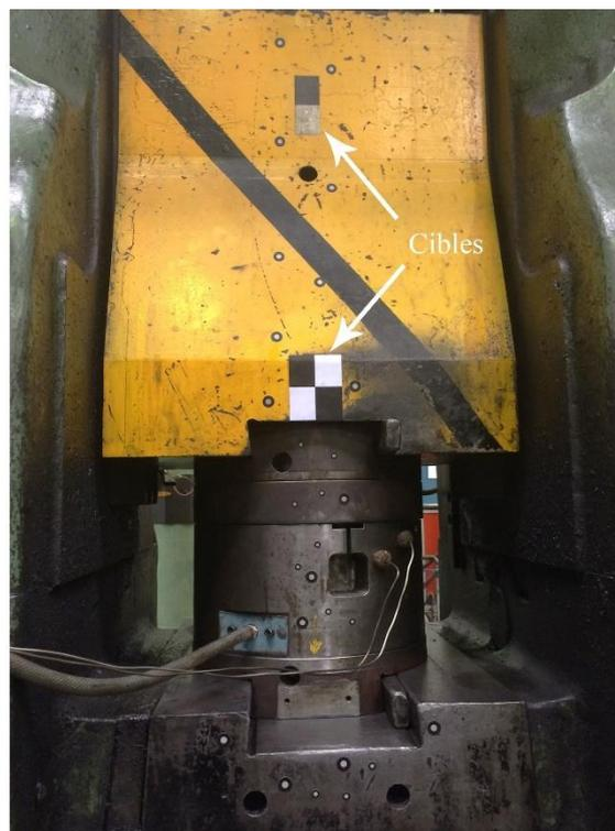
Figure III-13 Masse tombante du pilon simple-effet avec les cibles utilisées pour l'étalonnage
