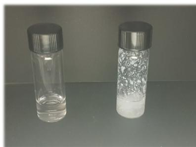
**Figure VI 1** Solution de pNIPAM dans de l'eau MilliQ à 20°C (à gauche) et dans une solution de NaCl à 2 mol.L<sup>-1</sup> (à droite).
