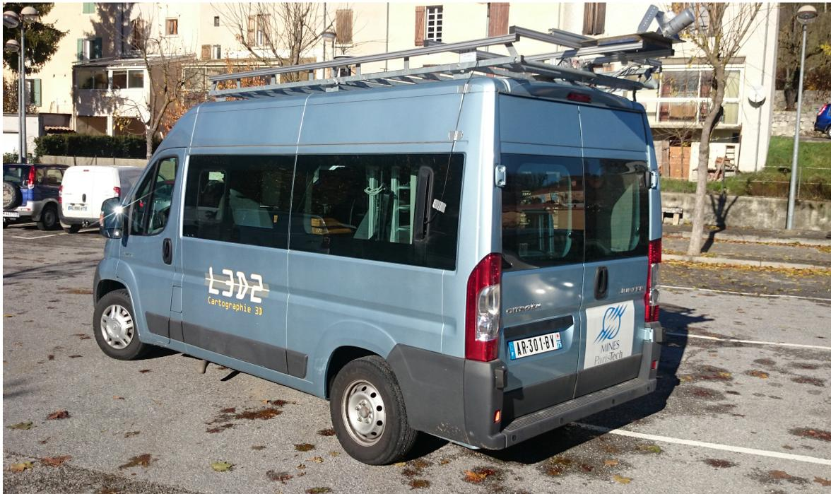
FIGURE 1.14 – La plateforme MLS expérimentale de Centre de Robotique : L3D2.
