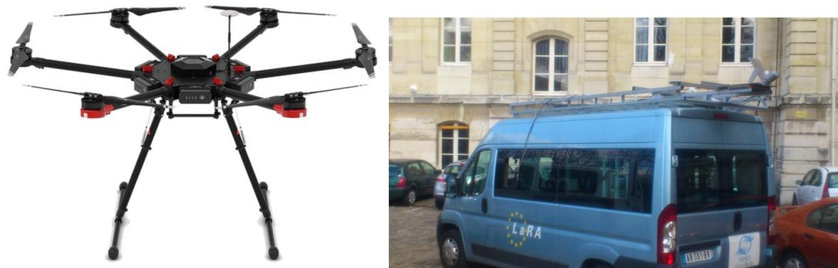
FIGURE 3.17 – Le drone du centre de robotique : un DJI M600 (à gauche), le véhicule expérimental : L3D2 (à droite)
