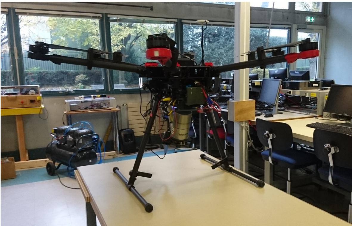
FIGURE 1 – Plateforme expérimentale LiDAR sur drone pour l'évaluation des méthodes de perception temps-réel en embarqué. Un drone équipé d'une nacelle comportant un LiDAR et un ordinateur embarqué.
