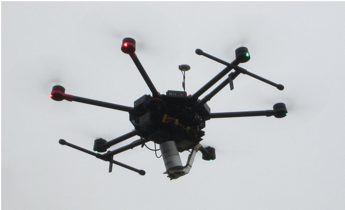
FIGURE 3.1 – Le système expérimental LiDAR aérien pour l'évaluation des algorithmes de perception temps-réel en embarqué.
