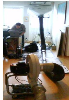
*Figure I.1.4 : Mesure sur l'air des performances d'une PAC*
