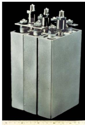
Figure 1-8 : Pack de batterie  $\text{Li}/\text{TiS}_2$  présenté par Exxon au salon Chicago Electric Vehicles en 1977. Chaque cellule présente une capacité de 45 Wh, et est composée d'un électrolyte à base de  $\text{LiClO}_4$  dans du dioxolane, d'après Whittingham [23].
