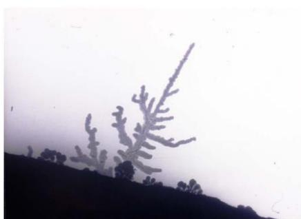
Figure 1-12 : Dendrites de lithium formées par électrodépôt de lithium, d'après Chianelli [41].
