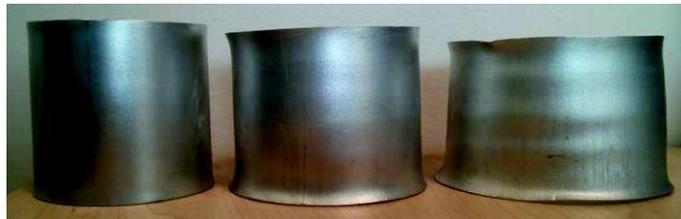
**c.** Tubes, déformés avec anneaux et la bobine en Glidcop à 17 spires. Déformations circonférentielles atteintes à mi-hauteur : 0.20, 0.30, 0.44
