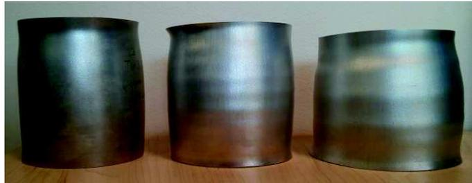
**b.** Tubes, déformés avec anneaux et la bobine en acier à 11 spires. Déformations circonférentielles atteintes à mi-hauteur : 0.24, 0.30, 0.42
