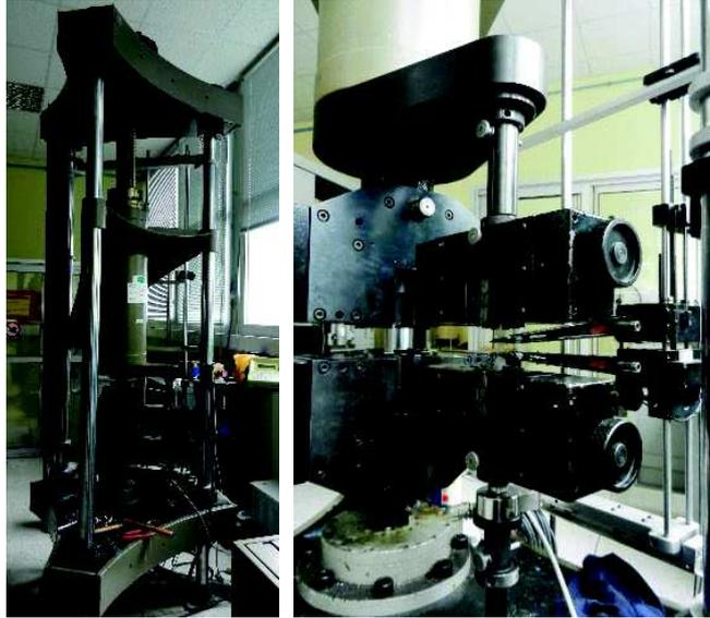
Figure III-10 : Dispositif expérimental pour les essais de traction quasi-statique
