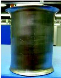
**a.** Tube sans anneaux, déformé avec la bobine en acier à 11 spires
