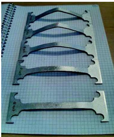
a. Eprouvettes déformées à 5 kV, 5.5 kV, 6 kV, 6.5 kV et 7 kV (de bas en haut)
