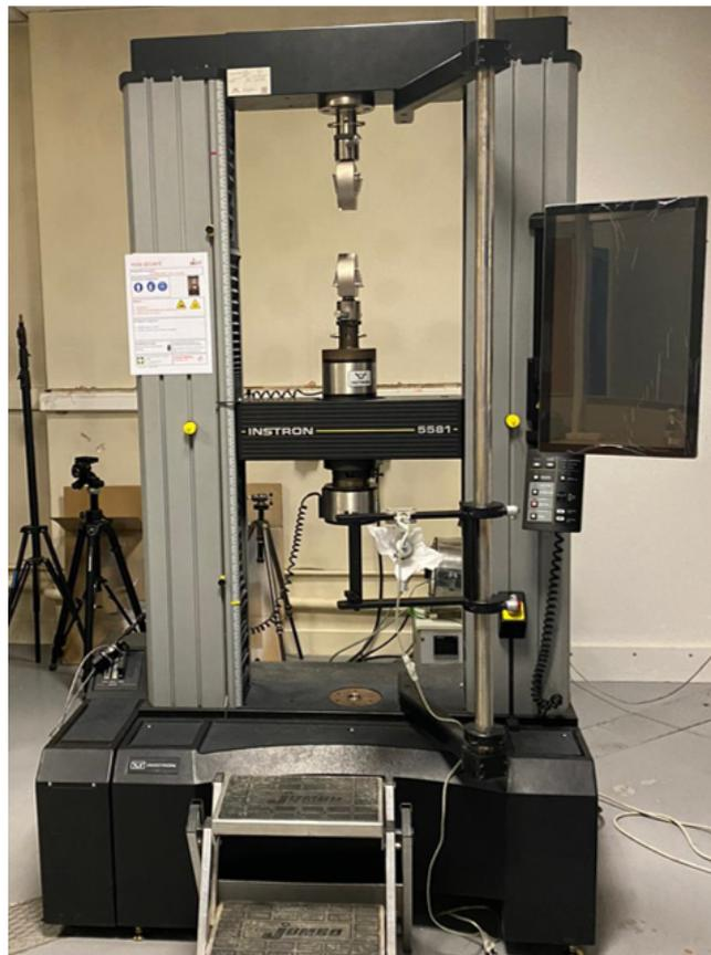
FIGURE 2.10 – Machine d'essais utilisée pour la caractérisation expérimentale
