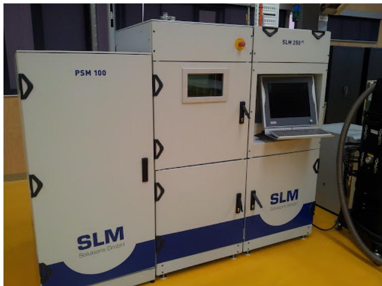
FIGURE 2.2 – Imprimante SLM utilisée, avec son tamiseur de poudre PSM100
