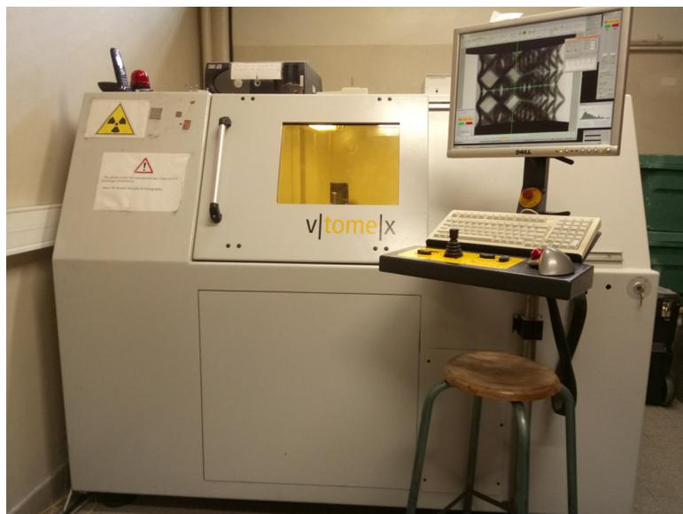
FIGURE 2.14 – Tomographe à rayons X v|tome|x s du MATEIS
