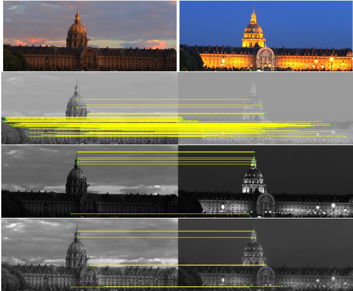
Figure 8.7 – Repeated Keypoints . Row I: 2 images HDR de la scène Invalides prises à différentes heures du jour. Les images HDR sont affichées après la mise à l'échelle du journal [27]. Row II: les points clés répétés en utilisant notre DetTMO proposé (66 points clés répétés sur les 200 points clés les plus forts). Row III: les points clés répétés à l'aide de Reinhard TMO (7 points clés répétés sur les 200 points clés les plus forts). Row IV: les points clés répétés à l'aide de MantiukTMO (5 points clés répétés sur les 200 points clés les plus forts).
