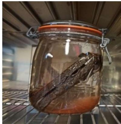
Figure 48- vieillissement sous 100 % HR (en immersion dans l'eau déminéralisée)
