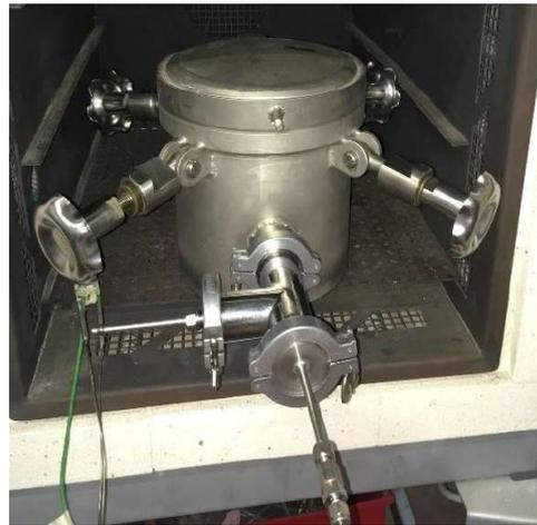
Figure 46- Cloche hermétique installée dans l'enceinte de régulation thermique au Cetim de Nantes
