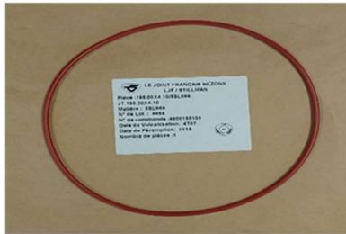
Figure 34- Joint torique en silicone VMQ (lot 4464) à l'état neuf
