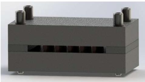
Figure 35- Plan 3D du montage de DRC sous compression seule conçu avec SolidWorks
