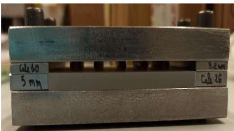
Figure 37- Montage de DRC sous compression seule au contact du PP
