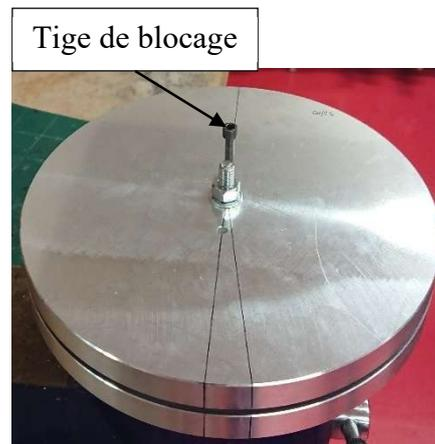
Figure 44- Montage de DRC après compression et cisaillement du joint
