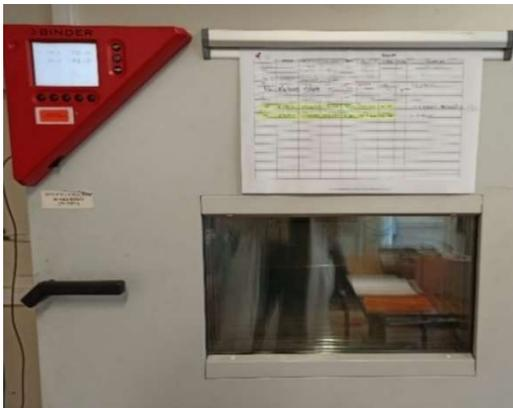
Figure 47- Etuve humide permettant une régulation en température et en humidité
