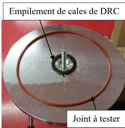
Figure 43- Positionnement du joint complet sur le montage de DRC sous compression/cisaillement
