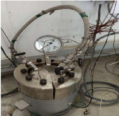
Figure 45- Hyperbare permettant de réaliser des vieillissements sous divers gaz
