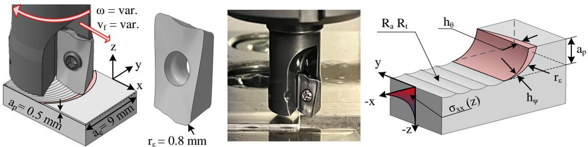
Figure 153. Configuration et paramètres opératoires utilisés pour l'usinage des éprouvettes en surfacage
