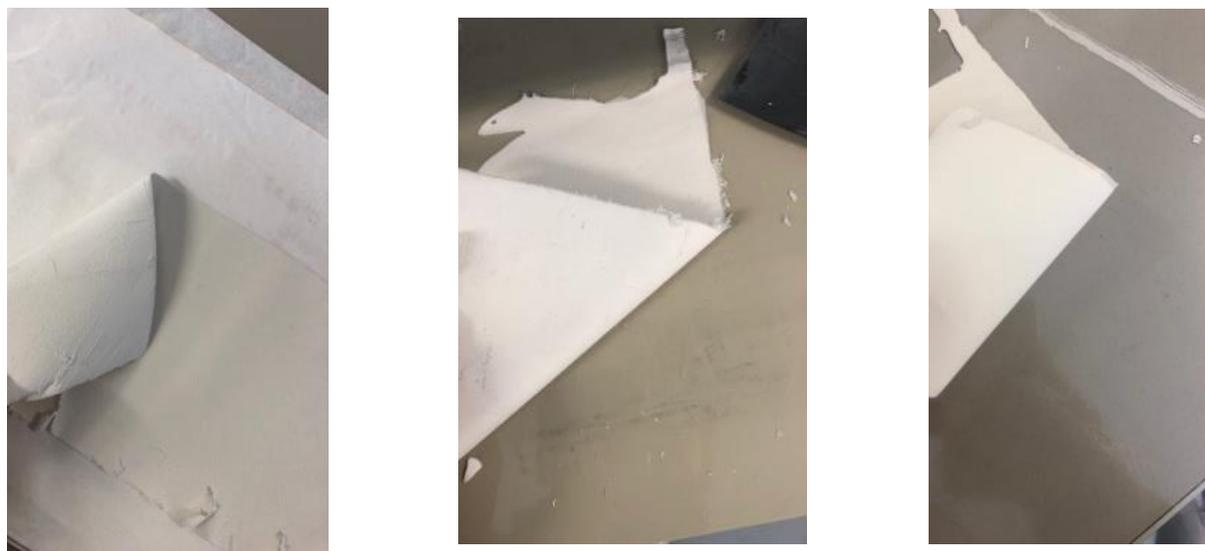
Fig. 6- Matrices coulées sur verre, polypropylène, et Mylar, de la gauche vers la droite, respectivement.
